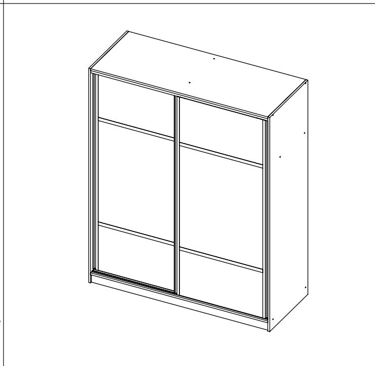
Donju vodilicu uvući od ruba za 20mm a gornju za 2mm !!! Vodilice pričvrstiti sa po 4 samonarezujuća vijka !!! Korak -4-
